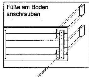
Zur besseren Aussteifung ist es notwendig, in manche Bretter zwei Schrauben zu schrauben. Bitte orientieren Sie sich an der Zeichnung.
