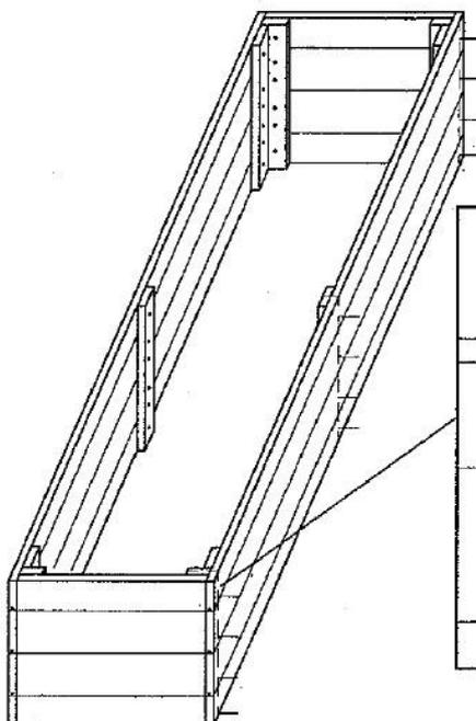
Die Bretter der langen Seiten etwa 30mm von der Außenkante mit der Leiste C1 der kurzen Seite verschrauben. Vorbohren mit  $\varnothing$  4mm verhindert EinreiÙen des Holzes
